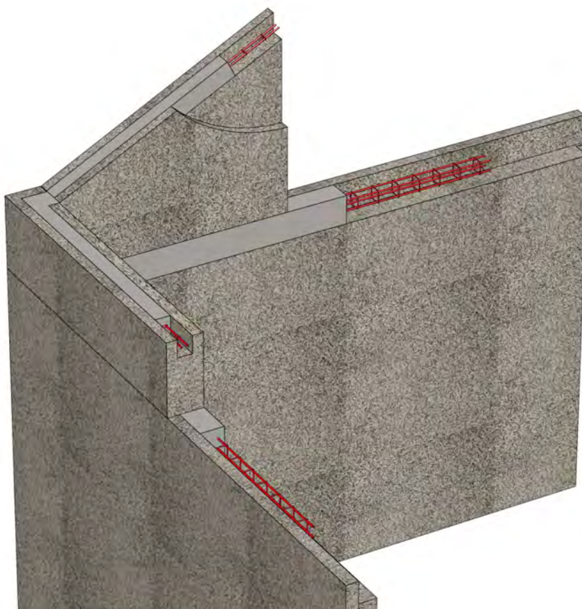
Figure A21 : Visuel principe chaînage rampant
