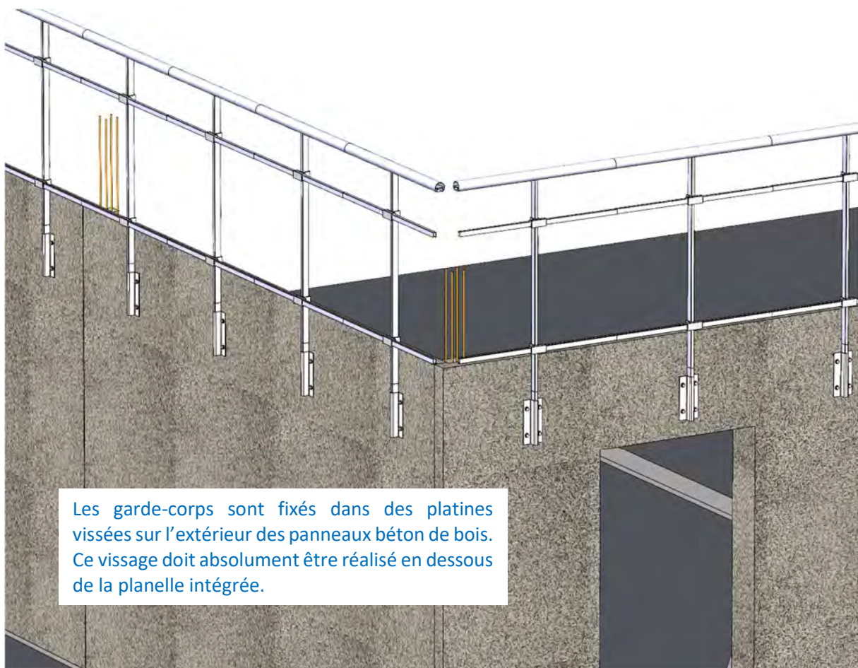
Figure A38 : Mise en place d'une protection collective par garde-corps
