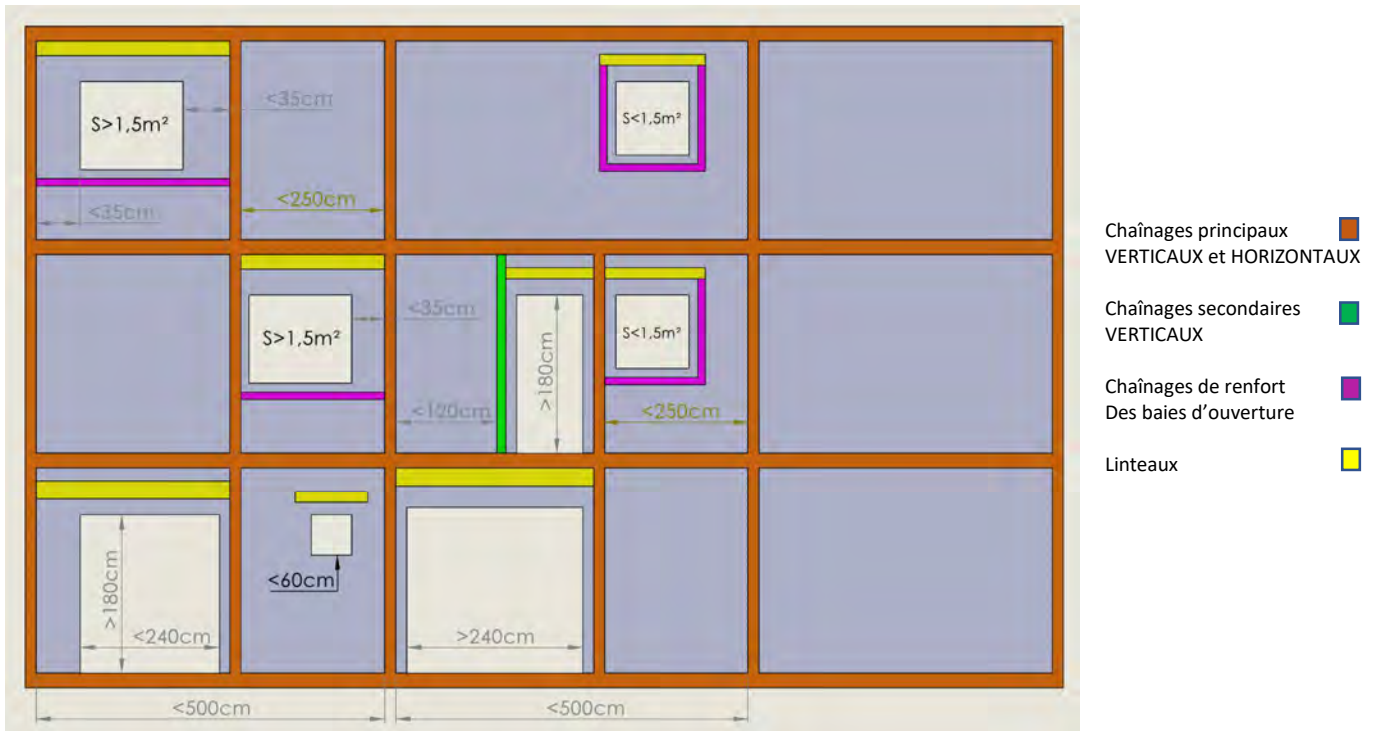
Figure A29 : Dispositions de principe des chaînages pour les configurations D, E et F – hors analyse de structure ou exigences particulières :
