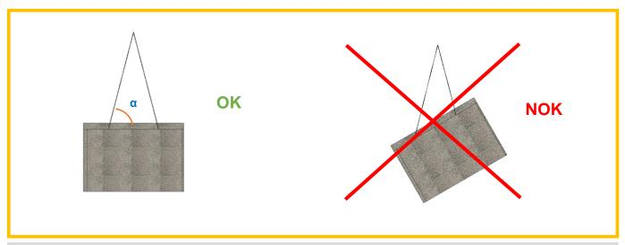
L'angle minimum d'élingage  $\alpha=60^\circ$  et les longueurs des élingues adaptées pour respecter l'angle minimum. Une longueur d'élingue L (plan avec cote L), correspondant à la longueur L du panneau, permet de garantir un angle minimum de  $60^\circ$ .
