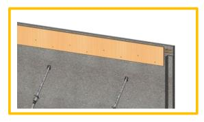
Il est conseiller de préalablement tracer la position basse des coffrages à disposer et de visser un tasseau bois (de l'ordre de 25\*25mm) en horizontal sur cette position afin d'appuyer ensuite les planches de coffrage et les visser aisément (en particulier si le travail de pose des coffrages se fait avec une seule personne).
