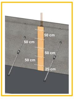
Pour certains types de coffrages, il peut être nécessaire de renforcer avec des bastaings en bois ou des serrejoints.
