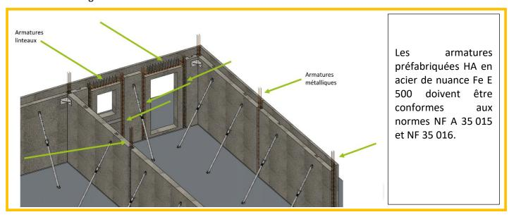
Il peut être avantageux de poser les armatures verticales dans les angles à la progression de la pose des panneaux.
