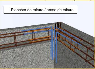
En phase de chantier, il est nécessaire de protéger les têtes des attentes de chaînages pour éviter les risques d'accidents ou de blessures.
