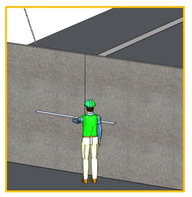
Pour réaliser l'alignement d'un niveau sur l'autre, on peut également fixer des sections de madrier sur les faces extérieurs du niveau inférieur pour servir de butée lors de la pose des panneaux du niveau supérieur.
