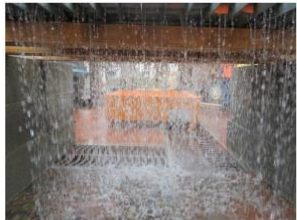
Photo de l'infiltration d'eau en sous face de la dalle drainante lors de l'essai au CERIB
